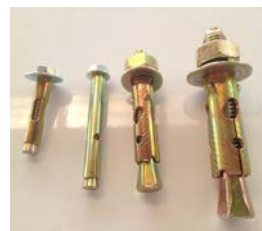
>> อุปกรณ์ก่อสร้างในปัจจุบันประเภททุก ใช้หลักการคล้ายกับการยึดคานไม้เข้ากับหน้าผาที่วัดเสวียนคง คือให้ปลายด้านในของตัวพุกเข้าไปขยายอัดแน่นข้างในเนื้อผนัง
