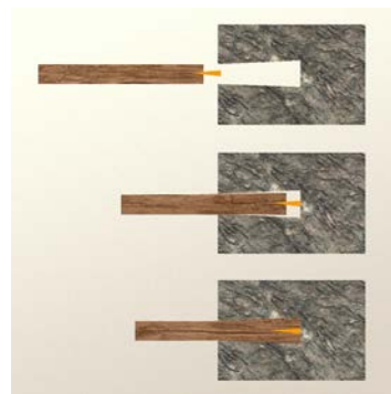
>> ภาพแสดงการตอกลิ้มเข้าทำยคานไม้เพื่ออัดให้เนื้อไม้เบียดเต็มเข้ากับช่องที่เจาะหินผาอย่างแน่นหนา
